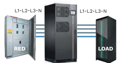
instalación de 4 conductores (L1-L2-L3-N)
